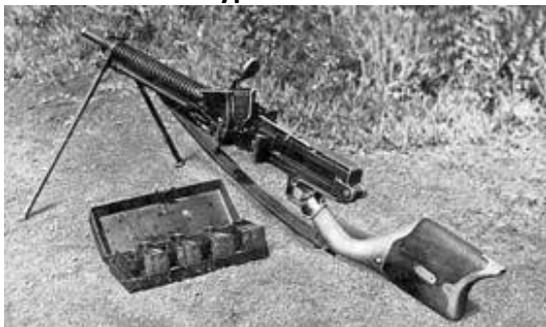
Une copie du fusil mitrailleur Hotchkiss. Était alimentée en cartouches par une trémie un système qui ressemblait à un entonnoir.
